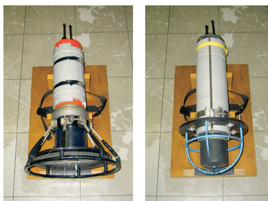
写真1 新旧トランスデューサ (左: 3号機, 右1号機)
