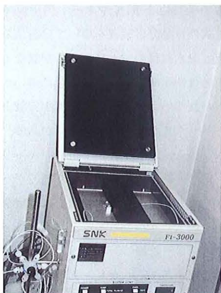
写真3 FIA システム FI-3000の恒温槽部分の写真 Photo.3 Thermostat section in FIA system FI-3000.
